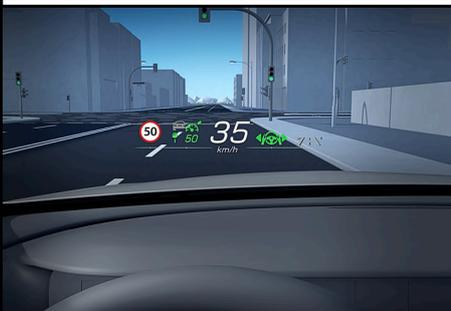
El Head Up Display convierte el parabrisas en un increíble puesto de conducción digital. Tendrá en todo momento la información más pertinente a la vista, sin desviar la atención del camino. La información mostrada, será la seleccionada por el conductor.
